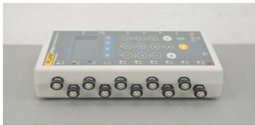
图4 MPS450多参数患者模拟仪
